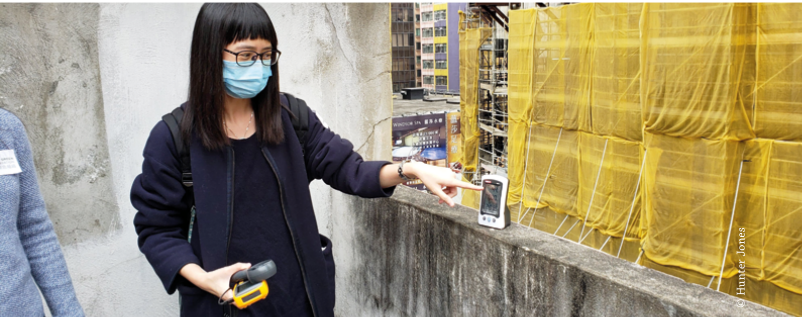
Mesure de la température et de la qualité de l'air dans un bâtiment résidentiel à proximité d'un chantier de construction.
